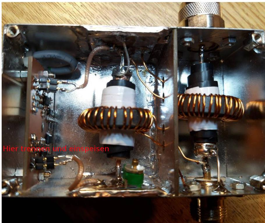
Hier sieht man ein Foto vom Richtkoppler. Durch die rechte Kammer fließt die hohe HF-Leistung und links ist die Auskopplung zur Messplatine. Dieses Metallgehäuse ist bei „<http://http://www.schubert-gehaeuse.de/>“ erhältlich, unter der Bezeichnung „Weißblechgehäuse 64x102x40“.
