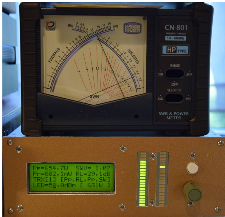
Anzeige bei 654 Watt Leistung.
