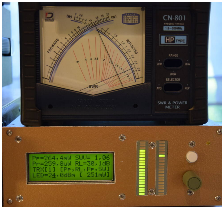
Anzeige bei 264 mWatt Leistung. Return Loss und SWV bleibt fast gleich.
