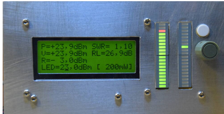
245 mWatt aus meiner Hermesbaugruppe mit der Anzeige der beiden LED-Zeilen. Links PEP rechts Return Loss.
