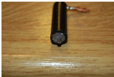
Die 2 Seite auch kurz absetzen und verzinnen. Achtung der Schirm wird hier abgeschnitten und darauf achten dass keine Fasern in Richtung Seele zeigen!!
