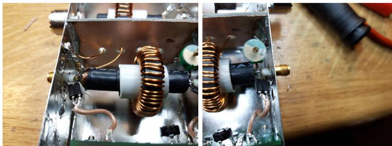
Auf beiden Seiten werden an das Koaxkabel RG178 die kleinen Buchsen für die Stiftleisten angelötet. Diese Trennstellen brauchen wir für die Messungen der Auskoppeldämpfung und Rückflußdämpfung.
