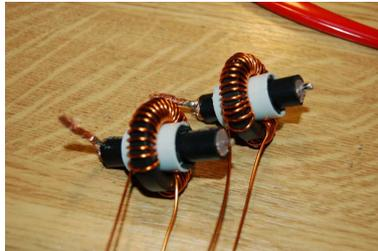
Die Ringkerne werden auf kurze Plasterrohrstücke geschoben. Das Plasterrohr habe ich aus dem Baumarkt. Der Außendurchmesser beträgt 16mm. Zwischen dem Plasterrohr und dem RG213 ist noch Luft. Ich habe den Zwischenraum mit Kabelmantel vom RG213 gefüllt.
