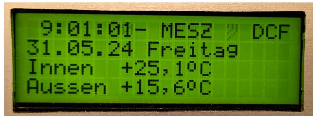
Nach Sekunde 0 wird die Korrekturrichtung 5 Sekundenlang angezeigt. Im Bild wurde abgerundet „-“. Die Uhr im PIC18F22K22 ging ein wenig vor.
