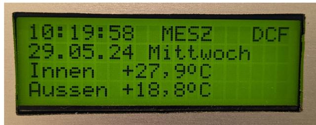
Datum und Zeit wird vollständig angezeigt und in Zeile 3 und Zeile 4 die Temperaturen.
