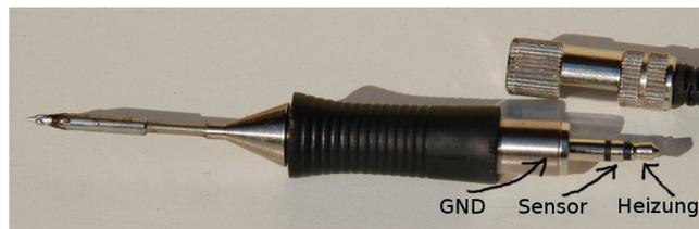
Hier ein Bild des Weller Lötkolbens RT1. Die Länge von der Spitze des Kolbens bis zum Ende des 3,5 mm Klinkensteckers beträgt nur 100 mm.
