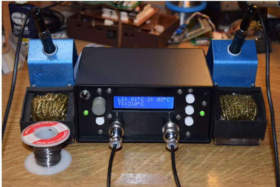
Fertige Lötstation. Beide Lötkolben laufen im Standby-Betrieb bei 80°C. Sind beide Lötkolben aktiv, werden nicht so viele Parameter angezeigt.
