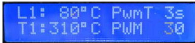
Ansicht des Displays, Nur Lötkolben links ist aktiv. L1=80°C (Lötkolbentemperatur Lk1, Standby-Temperatur), PwmT=3s (PWMmaxTimer beträgt 3 Sekunden) T1=310°C (gespeicherte Temperatur Taste 1), PWM=30 (Pulsweite Wert 30).
