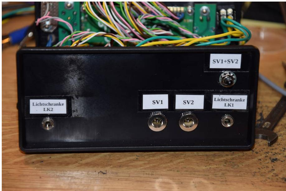
Die Lötstation von hinten. Links und rechts die Buchsen für die Lichtschranken (Standby-Betrieb). Die beiden getrennten SV-Eingänge. Und oben der Schalter für das Verbinden beider SV-Eingänge.
