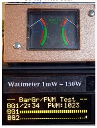
Die Anzeige in Zeile 3 simuliert eine Balkenanzeige und in Zeile 4 wird eine Punktanzeige simuliert. Bargraph und PWM stehen auf Vollausschlag.
