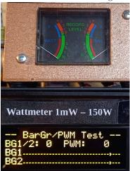
Mit dem Drehgeber wird ein Bargraph Ausschlag simuliert. Die PWM Ausgabe läuft parallel mit. Bargraph und PWM steht auf Wert 0.
