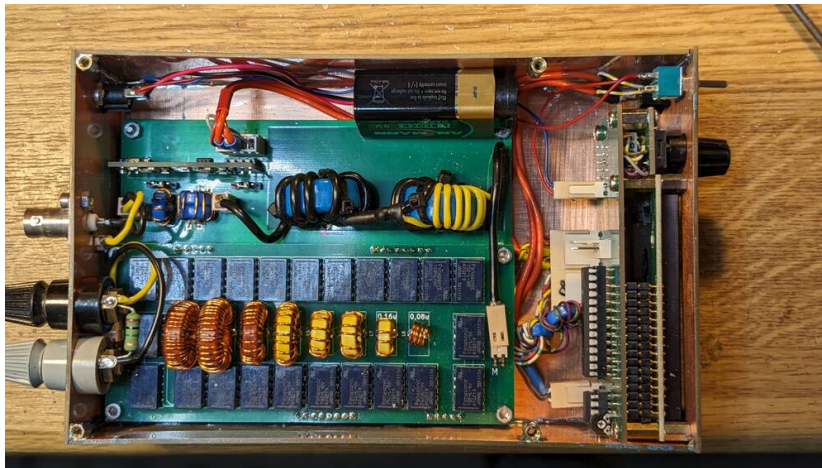
Innenansicht des PicATU20B. Oben links das Messmodul, darunter der Richtkoppler. In der Mitte der SymBa-QRP. Unten das LC-Glied, links die Anschlüsse für die Antenne und die BNC-Buchse. Rechts die mc-Platine mit Display und Bedienelemente.
