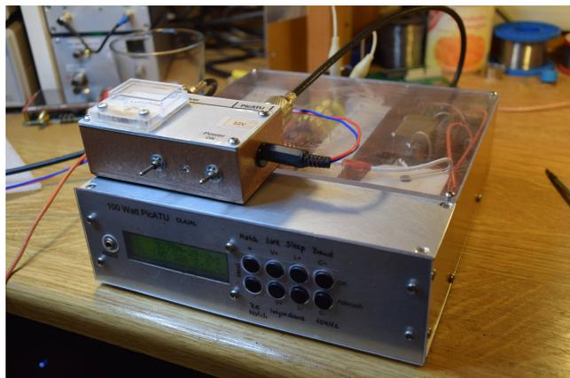
Im Bild der zweite PicATU100 Watt. Auf dem PicATU steht die Fernbedienung, rechts der PowerON Schalter und in der Mitte der Schalter für die Unterbrechungs-Steuerung.
