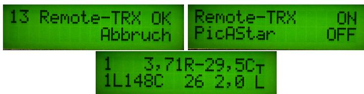
In diesem Menüpunkt wird die Übertragung von Befehlen zum PicATU per RS232 aktiviert. Das ist keine richtige RS232-Schnittstelle sondern nur eine TTL-Schnittstelle, digitale Übertragung im 5Volt Pegelbereich. Zusätzlich ist es weiterhin möglich die Fernsteuerung per SV-Unterbrechungen alle Befehle über das DDS-Menü des PicAStar auszulösen. Für die Übertragung von Befehlen über die RS232 braucht man ein zusätzliches Kabel von der *Fernsteuer-BG* zum *PicATU-RS232-Eingang*.
