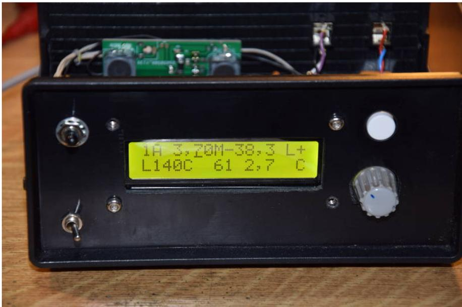
Hier noch einmal die neue Fernsteuer-Baugruppe mit geöffneten Gehäuse. Links in der Frontplatte die beiden Schalter. Oben der *PowerON-Schalter* und unten der *Fernsteuer-Schalter* für die 12V Unterbrechungen im Koaxkabel. Das ist eine Leiterplatte für sich.
