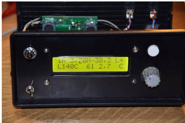
Die neuste Entwicklung ist die Fernsteuer-Baugruppe mit RS232-Steuerung. Im Display sehen wir alle Informationen, genau wie im Display des PicATU.
