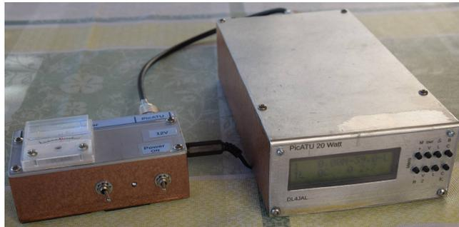
Hier die kleine PicATU20 Ausführung mit maximal 20 Watt Belastung. Für die Fernbedienung verwende ich die gleiche Baugruppe.
