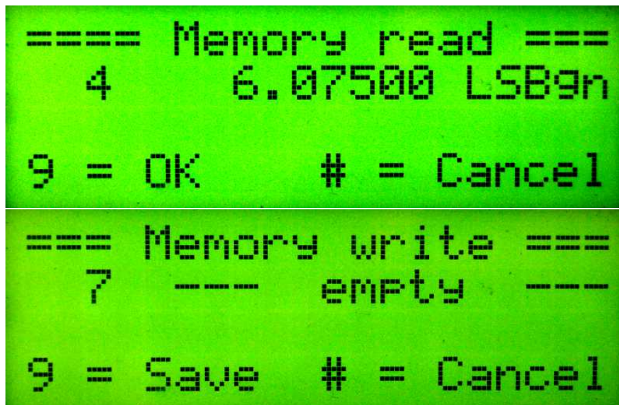
Abbildung 2.4: Im oberen Bild die Lesefunktion und darunter die Schreibfunktion in den Memoryspeicher. Es wird eine freie Speicherstelle beschrieben.
