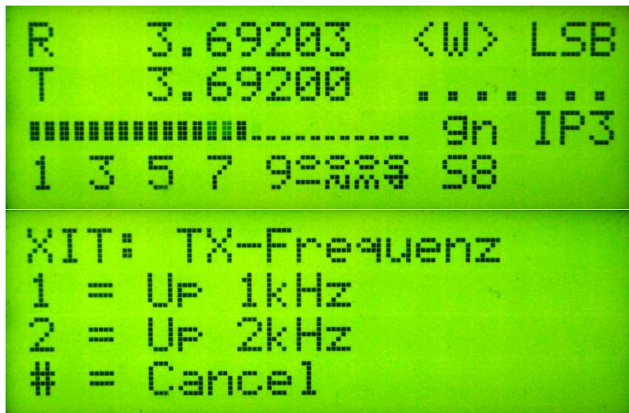
Abbildung 2.7: Im oberen Bild ist die RIT aktiv. Links steht „R“ „T“. Im unteren Bild sehen wir die Vorabfrage bei XIT.
