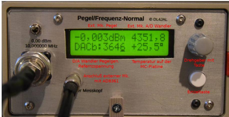
Bedeutung der Displaytexte und Bedienelemente. Der externe Messkopf ist angesteckt. Den Messkopf habe ich vorher auf *0,00 dBm kalibriert*. Ich musste den DACb-Wert etwas herunter drehen. Bei einer Temperatur von über 30°C ist DACb-Wert 3653.
