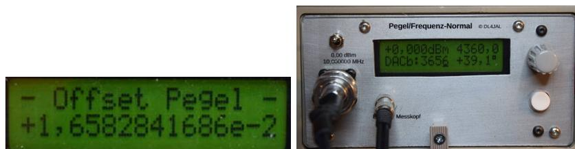
Der Offset-Wert wird angezeigt und mit bei der Messung des Messkopfes eingerechnet. Jetzt sind es genau 0,000 dBm aus unserem Pegelnormal.
