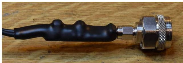
Die Platine im Schrumpfschlauch. Ich habe 2 Schrumpfschläuche verwendet. Zuerst innen eine Schrumpfschlauch einfach und außen einen Schrumpfschlauch mit Innenkleber. Ein N-Adapter ist aufgeschraubt.
