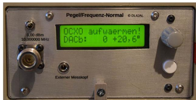
Display nach *PowerON*. Der OCXO muss erst warm werden. Die Referenzspannung für den Pegelgenerator ist auf 0 eingestellt. Erst wenn der OCXO warm ist, wird der DACb-Wert für den Pegel 0,00 dBm geladen.
