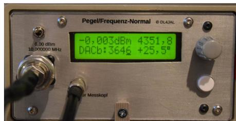
In diesem Beispiel habe ich den externen Messkopf zum Kalibriern verwendet. Der externe Messkopf wurde vorher auch wieder mit dem *0 dBm-Generator Homemade* auf 0,00 dBm kalibriert. Bei 26°C muss ich den D/A Wandler etwas zurück drehen. Steigt die Temperatur auf 30°C gilt wieder der DACb-Wert von 3653. Die Pegelabweichung ist aber nur 0,01 dB. Es ist also fast nichts.
