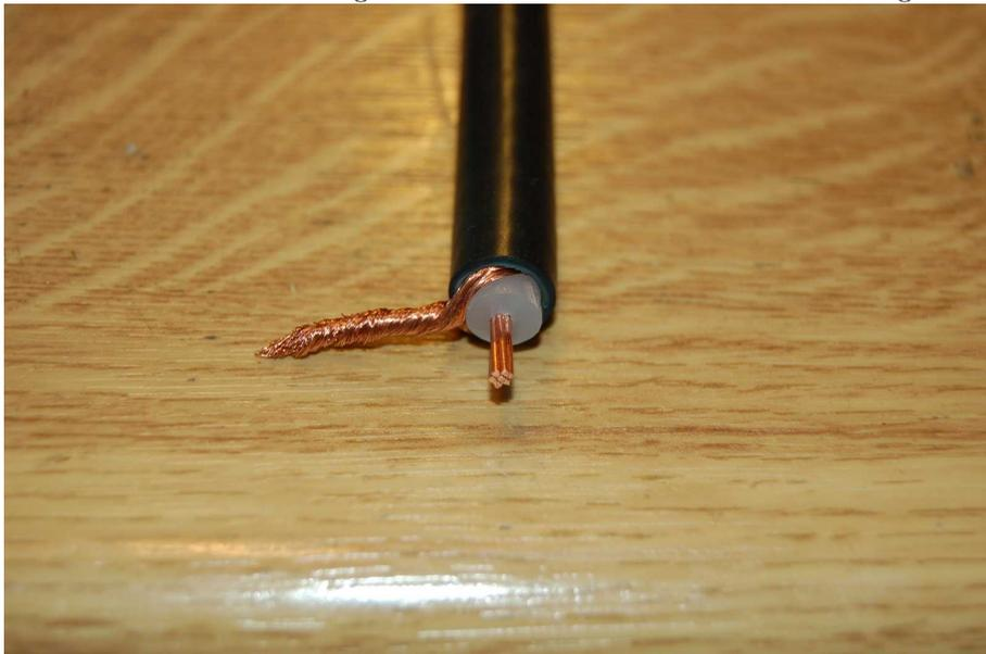
Die Seele wird ganz kurz abgesetzt um eine maximale Schirmung zu erreichen.
