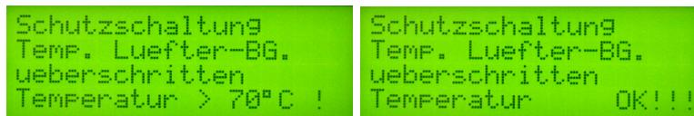
Abbildung 1: Links sehen wir die LCD auf der Hauptbaugruppe bei Temperaturüberschreitung eines Sensors der Baugruppe. Rechts ist die Meldeleitung wieder OK und die Schutzschaltung kann zurück gesetzt werden.
