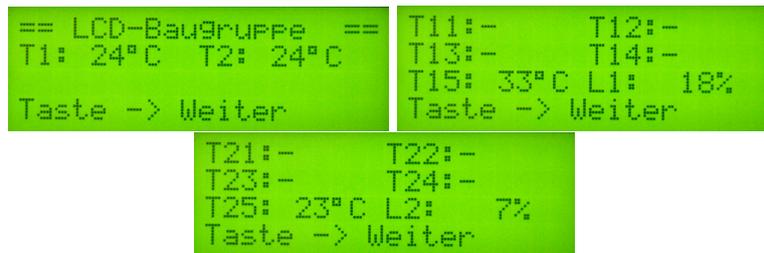
Abbildung 3.19: Alle Temperaturen im Überblick. Ist kein Sensor angeschlossen wird ein Strich dargestellt. Wie sehen, es sind 2 Lüfterbaugruppen angeschlossen.
