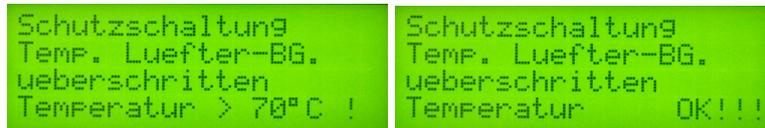
Abbildung 3.20: Geht die Meldeleitung auf LOW. löst sofort die Schutzschaltung in der SW aus, Bild links. Ist die Temperatur wieder gesunken wird die Anzeige geändert wie Bild rechts. Erst jetzt kann der Taster die „Resetfunktion“ der Schutzschaltung einleiten.
