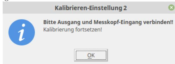
Das Dämpfungsglied wird entfernt und Eingang mit Ausgang verbunden. Das sind dann genau 0dB S21. Die Dämpfung des Kabels zwischen Eingang und Ausgang wird mit heraus kalibriert. Nach der Berechnung der Messteilheit
