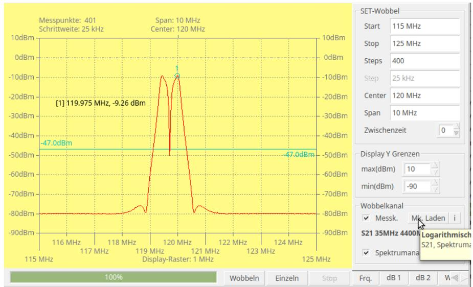
Nach dem Umschalten auf Spektrumanzeige unten rechts, wird der Pegel richtig angezeigt. Hier bei der Frequenz 120 MHz, Pegel -10 dBm. Anzeige -9,26 dBm.
