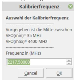
An diesem Frequenzpunkt wird die Funktion der Messteilheit des AD8307 ermittelt. Ich ändere diesen Frequenzvorschlag in eine Frequenz die ich im Pegel nachmessen kann. Ich nehme fast immer 100MHz.
