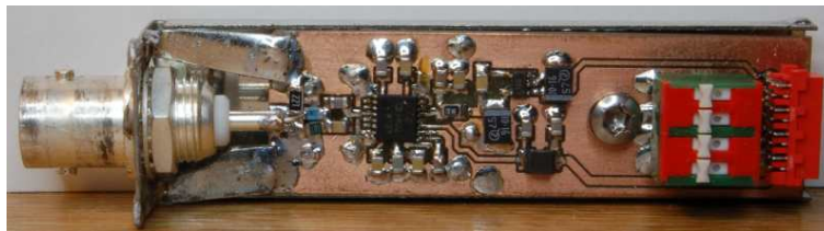
Hier noch die alte Ausführung mit Kodierschalter und Stecker vom Type „MICROMATCH-8“.
