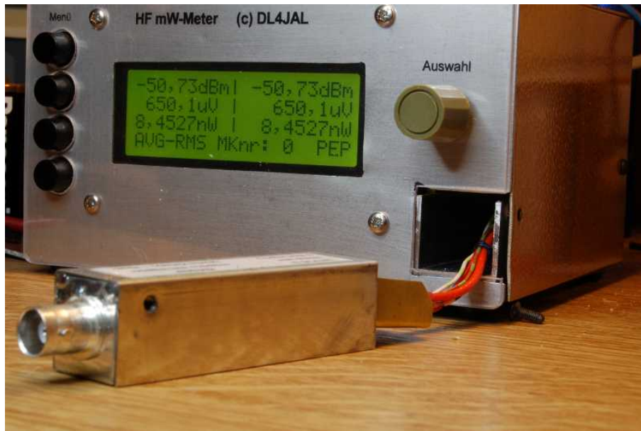
Abbildung 2.4: Der Messkopf aus dem Schacht herausgenommen.
