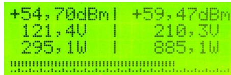
Abbildung 3.2: Ansicht der aktiven Bargraphanzeige
