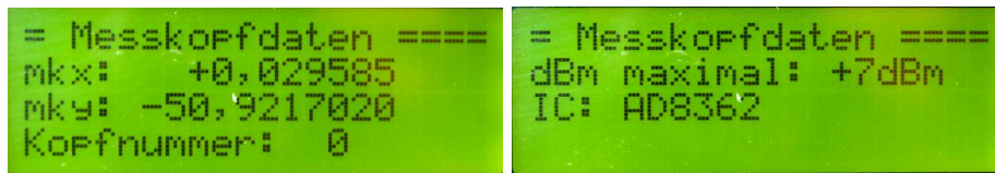
Abbildung 3.8: Es werden in Folge die Konstanten mkx, mky, Messkopfnummer, maximale Aussteuerung und Typ des Messkopfes angezeigt. Neu der neuen FW sehen wir hier die Zahlendarstellung im Exp-Format.
