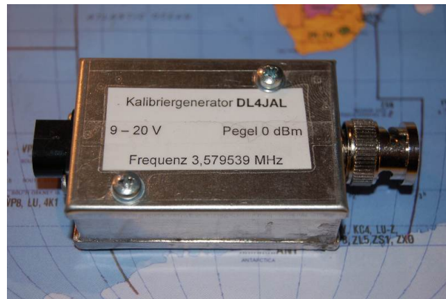
Abbildung 2.8: Der Kalibriergenerator im Gehäuse.
