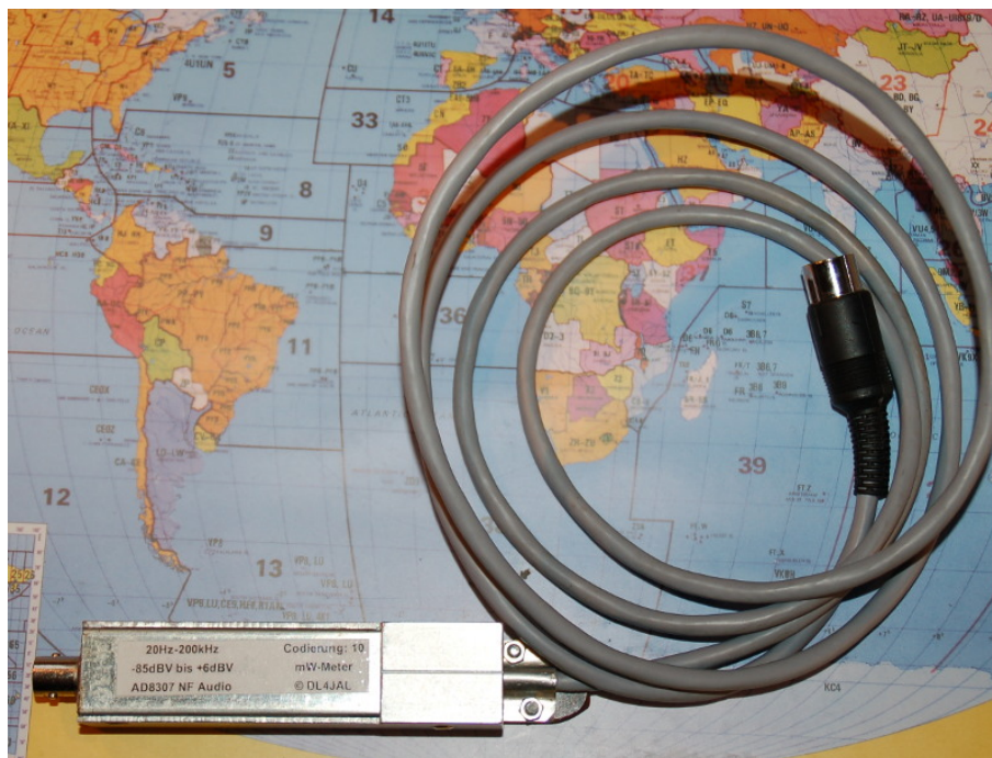
Abbildung 2.5: Mein neues Adapterkabel. Geeignet für das mW-Meter und den NWT01.
