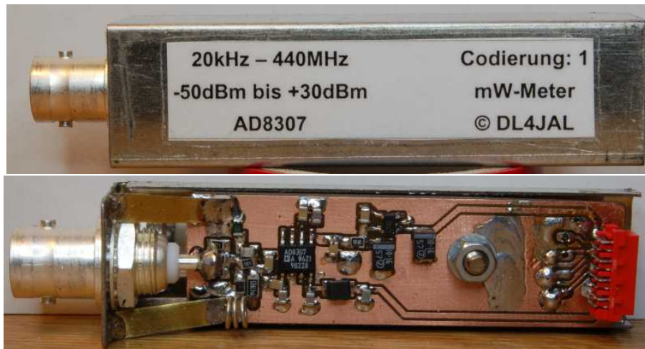
Abbildung 2.3: Der Messkopf mit dem IC AD8307.
