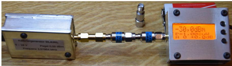
Nach Beenden des Kalibriervorganges zeigt die Anzeige -30 dBm an. Wir haben ja 2 Dämpfungsglieder von 10 dB und 20 dB vorgeschaltet. Der Attenuator wird auf 0 dB eingestellt „A 0“.
