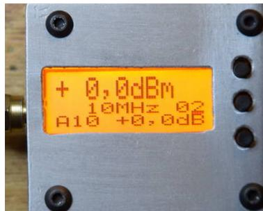
Mein DoppelVFO bei 10 MHz und einem Pegel von 0,0 dBm. Mit den Tasten 2 und 3 habe ich das Offset für diese Frequenz eingestellt. Mit der Taste 1 kann man die Position des Cursors ändern und den Index auch in 10er Schritten wechseln.
