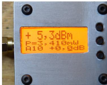
Ich habe mit dem „Power Meter, HP437B“ den Pegel meines Spektrumanalysers (Tracking Generator) bei 2,4 GHz gemessen. In der Einstellung 0 dBm am Siglent-TG wird ein Pegel von +1,34 dBm Pegel abgegeben. Auf Zehntel gerundet ist das +1,3 dBm. Im mW-Meter habe ich das 10 dB Dämpfungsglied schon eingestellt „A10“. Jetzt brauche ich nur das Offset so verstellen, so dass das Display „1,3 dBm“ anzeigt.
