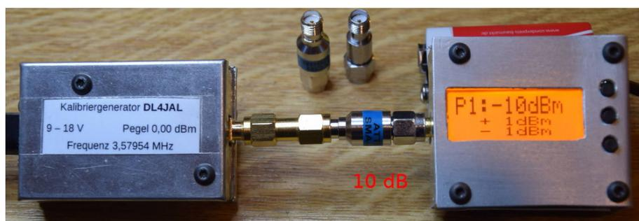
Zwischen unseren 0,0 dBm Generator und dem mW-Meter schleifen wir ein Dämpfungsglied von 10 dB ein. Im Display stellen wir -10 dBm ein. Weiter mit Taste 1.
