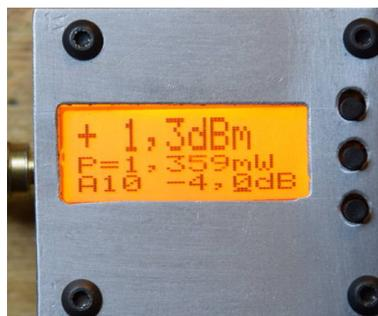
Das Offset stelle ich auf -4,0 dB. Die Anzeige zeigt jetzt 1,3 dBm an. Das ist der Pegel meines „Siglent-Trackinggenerators“ bei 2,4 GHz. Bei meiner Musterbaugruppen die ich mit SMD0402 aufgebaut habe ist die Offset-Einstellung nur -4,0 dB Bei den Baugruppen mit der SMD0603 Bestückung ist der Offsetwert anders. Siehe Tabelle auf Seite 6.
