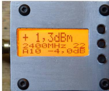
Im Bild der Pegel meines Siglent-TG bei 2,4 GHz. Mit den Tasten 2 und 3 wird die entsprechende Frequenz-Index ausgewählt. Mit der Taste 1 kann man die Position des Cursors ändern und den Index auch in 10er Schritten wechseln.
