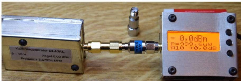
Stelle ich jetzt im Display noch das vorgeschaltete Dämpfungsglied von 10 dB ein, „A10“, muss das Display 0,0dBm Anzeigen.
