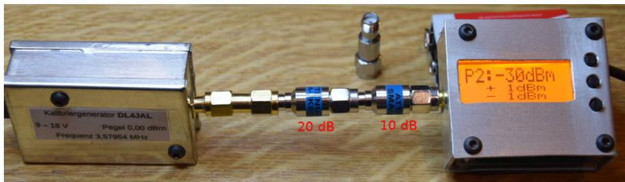
Zwischen unseren 0,0 dBm Generator und dem mW-Meter schleifen wir noch ein Dämpfungsglied von 20 dB zusätzlich ein. Das ergibt einen Pegel vom -30 dBm. Im Display stellen wir -30 dBm ein. Weiter mit Taste 1.
