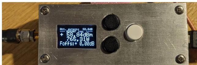
Leistungsmessung mit externer Dummy-Load.
