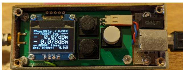
Das mW-Meter geöffnet. Rechts der USB-Anschluss für die SV. Darüber der DC-DC Wandler. 0,0dBm am Messeingang von meinem Pegel-Frequenznormal. Die -0,07dB ist die Dämpfung des Messkabels von etwa 1m.
