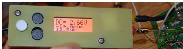
Am Eingang beträgt die Gleichspannung 2,66V und der Pegel -19dBm.
