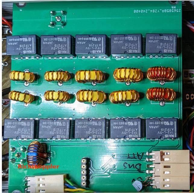
Ein Foto von der Tiefpass-Platine. Unten links der Ringkern vom Richtkoppler. Die Steckverbindung darunter führt zur MC-Platine, Auswertung der Messungen.
