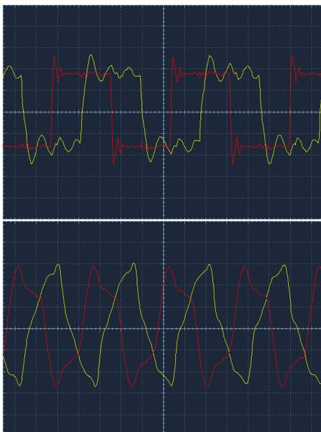
Ich habe Oszillogramme vom Ausgang *CLK0* und *CLK1* im 80m-Band (oben) und 10m-Band (unten). In beiden Bildern ist die Phasenverschiebung der Signale gut zu sehen.
