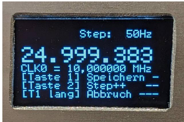
Mit dem Drehgeber(VFO) verändern wir die Taktfrequenz so lange bis an CLK0 des Modules genau 10.000.000 Hz ausgegeben werden. Vergleichen können wir die 10MHz mit einem GPS-Normal 10MHz und einen analogen Oszi (2 Kanäle).
