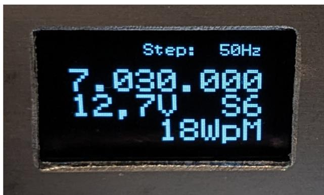
Der Empfänger steht auf 7,030 MHz. Die Schrittweite beim Abstimmen beträgt 50Hz. Die Betriebsspannung ist 12,7 Volt. Das S-Meter zeigt *S6* an und der Keyer ist auf *18 Wörter pro Minute* eingestellt.
