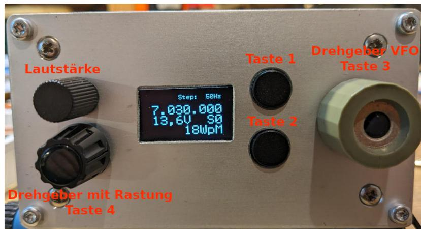
Oben links das Poti für die Lautstärke. Rechts der Drehgeber ohne Rastung für den VFO mit Tastenfunktion Taste 3. Links unten der Drehgeber mit Rastung und Tastenfunktion Taste 4 und Taste 1 und Taste 2
