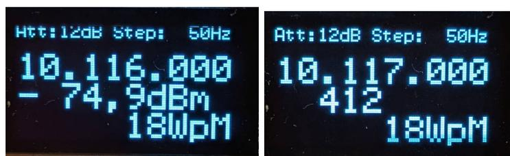
Links der Empfangspegel in dBm und rechts der Wert des AD-Wandlers. Die anderen Anzeigen in Zeile 3, „Spannung-SV“ und „L“ entfallen.
