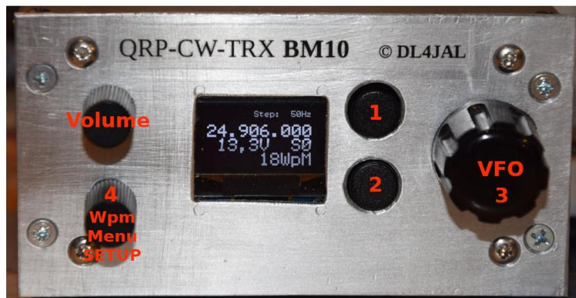
Oben links das Poti für die Lautstärke. Darunter der Drehgeber mit Rastung und deren Tastenfunktion entspricht der *Taste 4*. Rechts der Drehgeber ohne Rastung ist für den VFO. Die Tastenfunktion diese Dregebers entspricht der *Taste 3*. Rechst neben dem Display befinden sich die beiden Einzeltasten *Taste 1* und *Taste 2*.
