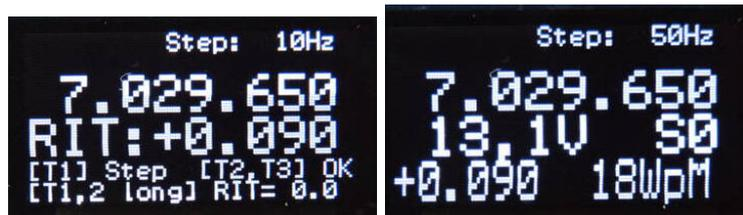
(Links) befinden wir uns im Edit-Modus der RIT-Funktion und können die Empfangsfrequenz verstellen. Nachdem eine RIT-Frequenz eingestellt wurde und die Funktion verlassen wird, ändert sich das Display (Bild rechts). Ist RIT aktiv sieht man die Frequenzablage in der untersten Zeile links.
