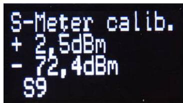
Mit dem Drehgeber korrigieren wir, bis der Pegel am RX-Eingang etwa mit dem Pegel im Display überein stimmt.
