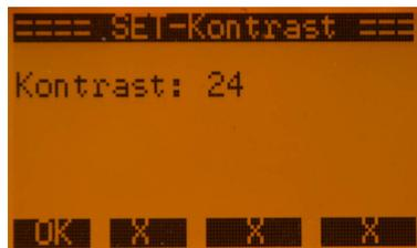
Der Kontrast ist auf einem Mittelwert eingestellt. Sollte es notwendig sein, den Kontrast zu verbessern, kann das hier geschehen. Mit „OK“ wird wieder abgespeichert.
