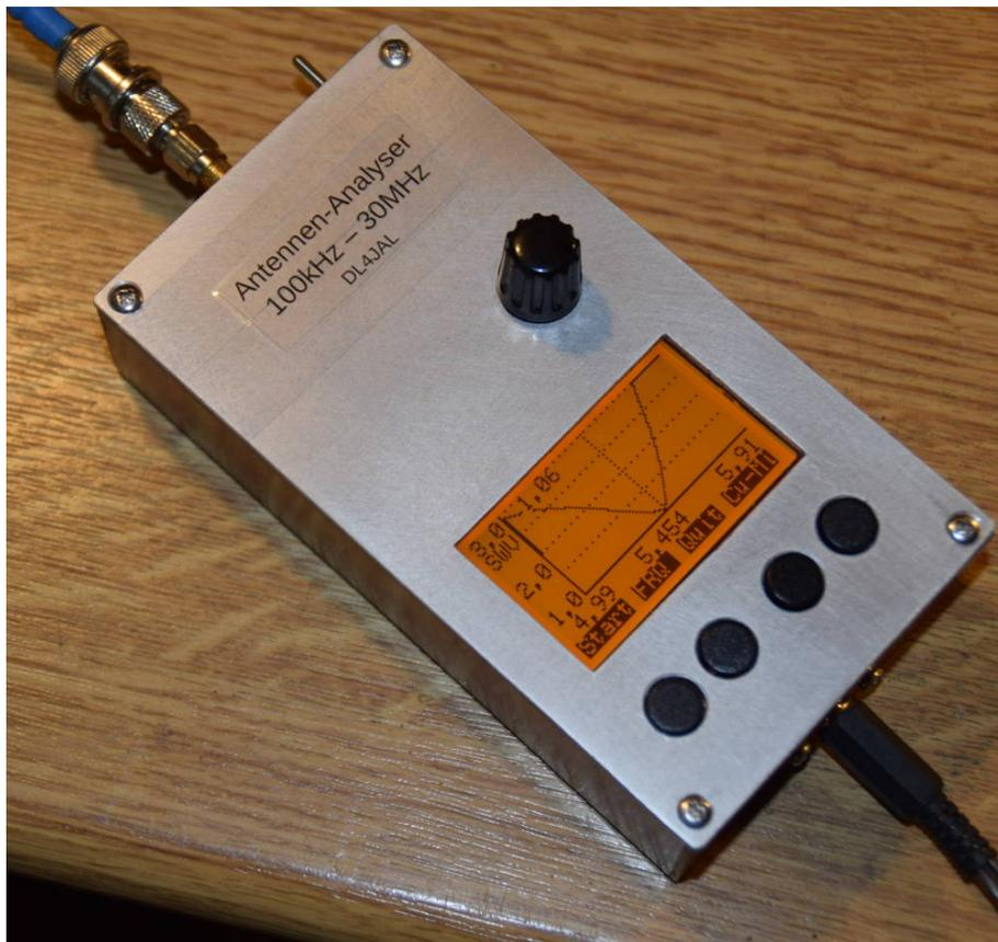
Hier ist der erste Prototyp zu sehen. Bei diesem Gerät habe ich noch einen größeren PIC18F46K22 in SMD verwendet. Zum Glück konnte ich die Verwendung der PINs reduzieren und den PIC18F26K22 in DIL verwenden.
