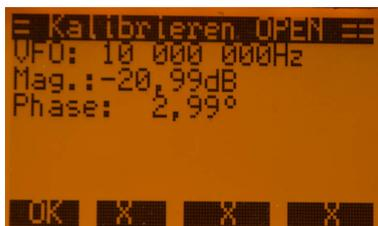
Diese Funktion wird beim ersten PowerON zwangsweise ausgeführt. Es wird bei Messeingang „OPEN (Offen)“ die Differenz der Magnitude zu 0dB festgestellt und im internen Eeprom abgespeichert. Diesen Wert braucht die Software für die Berechnung des genauen Reflexionsfaktors. Erläuterungen dazu finden wir im Kapitel 2.2. Ich hatte anfangs noch die Phase mit in der Grundkalibrierung. Das habe ich wieder entfernt, weil es nicht nötig war.
