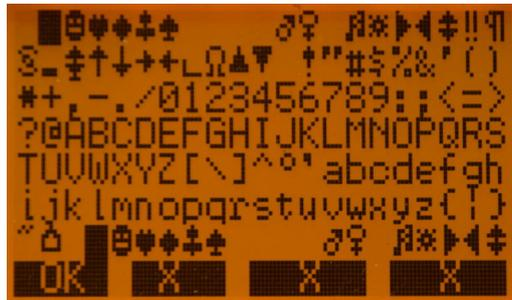
Der Zeichensatz für die Textausgabe befindet sich nicht im LCD-Display sondern im Rom des Mikroprozessors. Welche Zeichen implementiert wurden ist in dieser Funktion ersichtlich. Ich brauche diese Funktion für die Softwareentwicklung.
