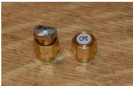
Für die Kalibrierung „SHORT“ verwende ich einen SMA-Stecker mit einem Kurzschluss. Den Kurzschluss bildet ein kleines Messingblech, was ich ringsherum verlötet habe. Der „LOAD“-Stecker ist handelsüblich. Ich habe ihn bei der HAM-Radio in Friedrichshafen erstanden. „OPEN“ ist bei mir nur der offene Eingang. Das ist für die maximal 30 MHz Messfrequenz ausreichend.
