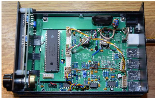
Geöffneter QCX+. Der Umbau ist fertig. Das Band-Modul für das 40m-Band ist gesteckt.
