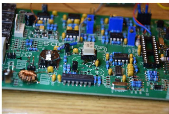
Die Beinchen der 6-poligen Fassung müssen etwas verbogen werden. Sonst passt es nicht. Rechts hinter dem Kondensator C6 werden kurze Drähte eingelötet.
