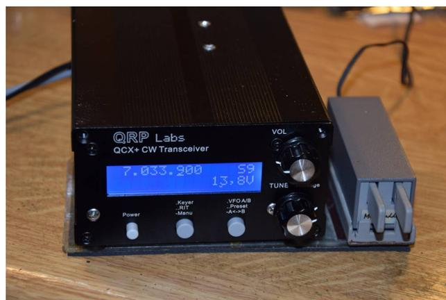
Die Anzeige der Batterie-Spannung und die S-Meter-Anzeige ist aktiviert. Ein RX-Signal mit S9 wird empfangen.
