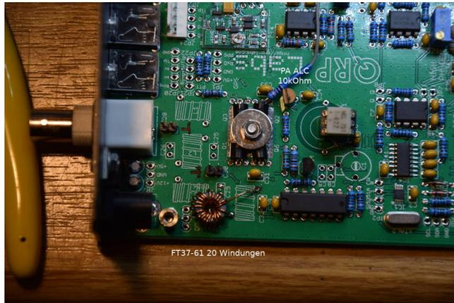
Für L4 wird auch ein anderer Ringkern eingelötet, wie im Bild zu sehen ist. Die Class-E-Pa soll ja auf allen Bändern möglichst gleich gut funktionieren. L4 wird flach gelegt, da die schmale Aufnahmeplatte für die Steckmodule und Richtkoppler darüber montiert wird.
