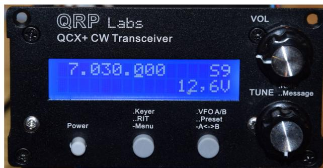
Ganz links ist die Taste *Power*. In der Mitte die beiden Tasten haben mehrere Funktionen. Rechts unten ist der Drehgeber. Ich habe einen Drehgeber ohne Rastung eingebaut. Normal liefert der Drehgeber pro Umdrehung 24 Impulse.
