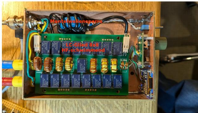
Noch einmal das Bild mit dem Innenleben des Tuners. Oben ist die Mantelwellensperre zu sehen. Sie wird einfach unten auf der „mc\_rk.v1\_01, Steuerplatine“ an J6 angesteckt und oben an die LC-Glied-Platine J4.
