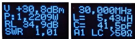
Bei einer Sendeleistung von etwa 1,2 Watt zeigt das Display immer etwa Return Loss 34 bis 35 dB an. Getestet habe ich mit 3,5 MHz, 10 MHz und 30 MHz. Gleichzeitig wird die Sendefrequenz gemessen. Bild rechts, das Frequenz-Messergebnis von 30 MHz. Im Hintergrund wurde die Frequenz gemessen. Die Werte von L und C haben hier nichts zu sagen, die Mantelwellensperre ist ja vom LC-Glied getrennt.
