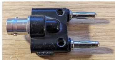
Steckt man diesen Adapter an die 2 Polklemmen, kann wieder Koaxkabel an die BNC-Buchse gesteckt werden.
