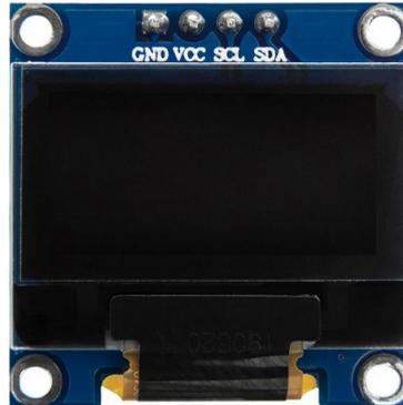
Das Display hat 4 Anschlüsse GND, VCC, SCL und SDA.
