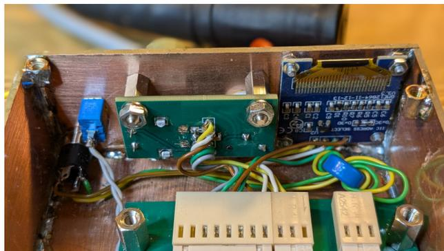
Die Ansicht der Frontseite von innen. Links unten ist der CAT-Anschluss für meinen PicAStar. Dann folgt der blaue EIN/AUS Schalter, die Bedienplatine mit Drehgeber und Taste. Rechts ist mit 2mm Schrauben das OLED-Display befestigt.
