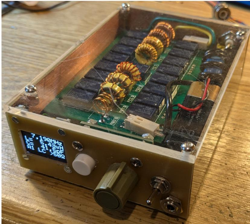
Hier ist der erste Musteraufbau des PicATUBmini zu sehen. Nach der Anpassung an die Antenne kann der PicATUBmini aus geschaltet werden. Durch den Einsatz von bistabilen Relais bleibt die gefundene Einstellung auch im ausgeschalteten Zustand erhalten. Nach PowerON wird wieder die letzte Frequenz mit der letzten Einstellung geladen.
