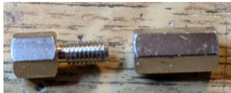
Bevor die 5-poligen Verbindungsleisten und Buchsen eingelötet werden muss der Abstand beider Platinen genau stimmen. Deshalb werden zuerst die Abstandsbolzen angeschraubt. Die Stiftleisten und Buchsen werden zusammen gesteckt und zwischen den Platinen justiert und erst wenn die Platinen zusammen geschraubt sind, eingelötet.
