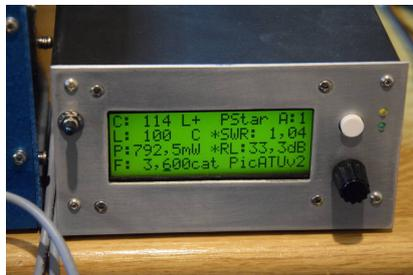
Im Display der Fernbedienung sehen wir, beim Senden, die Anpassung und Sendeleistung, die am Richtkoppler anliegt.
