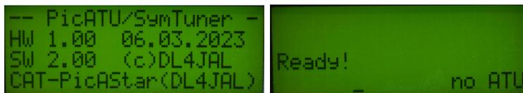
Links die Versionen von HW, SW und das Datum der letzten SW Version nach „Power ON“. Anschließend „Ready“ und die gelbe LED blinkt aller 5 Sekunden kurz auf. Das bedeutet ein Datensatz wird von der Fernbedienung zum PicATU gesendet. Es wurde noch kein ATU erkannt. Die Datenverbindung zum ATU fehlt noch.
