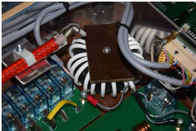
Mantelwellensperre mit DXW50 in meinem zweiten Musteraufbau. Die Sperrwirkung ist groß genug, selbst bei 1,8 MHz.
