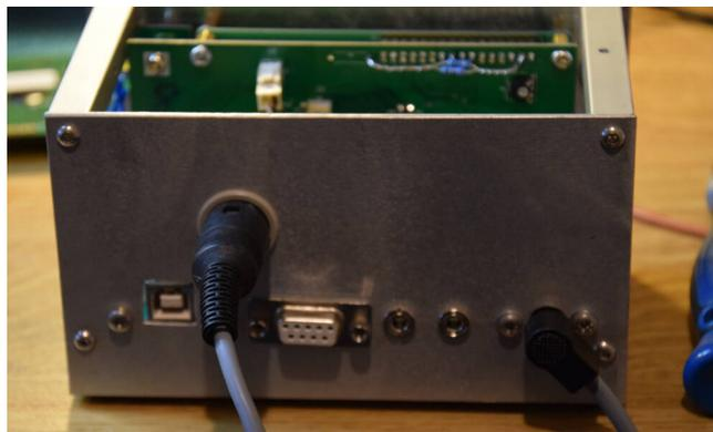
An der Rückseite befinden sich die Anschlüsse. USB, das Fernbedienkabel, die RS232, 3mm Klinke CV-I oder PicAStar, RS232 Splitfilter (nur für DL4JAL) und die Stromversorgung 12V.
