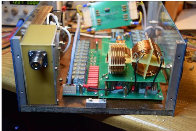
Ohne Blech von hinten. Links der Richtkoppler. In der Mitte das C-Glied mit den 11 Relais und rechts das L-Glied, vorn mit den beiden Spulen 8uH und 16uH.
