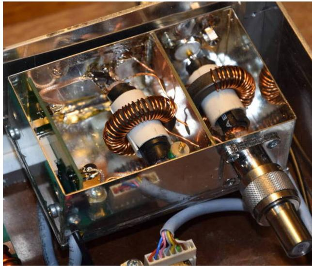
Hier noch der Richtkoppler aus meinem vorherigen Mustergerät. Ganz links ist die Messplatine. In der gleichen Kammer ist der Spannungsübertrager 36:1 und in der rechten Kammer der Stromübertrager 36:1. Hier noch mit FT 114-43. Im neuen Richtkoppler habe ich einen kleineren Ringkern FT 82-43 genommen.
