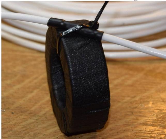
Mit Schrumpfschlauch überzogen und am Ringkern befestigt.
