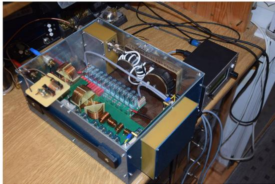
Blick von oben ins Innere des Tuners. Das L-Glied mit Luftspulen. Hinten rechts die Mantelwellensperre und der Symmetrieübertrager für große Leistung. Links auf dem Tuner liegt die Kunstantenne zum Testen des Abstimmverhaltens.
