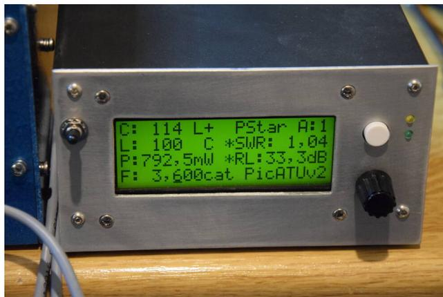
Die Fernbedienung, das Display beim Senden. Es wird die Sendeleistung, Return-Loss und das SWR angezeigt. Rechts befinden sich die 2 LED's für die Datenflusskontrolle. Rechts ist noch der Drehgeber und die Einzel-Taste (weis) zu sehen.
