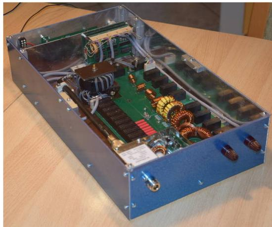
PicATU500 von hinten. Links die N-Buchse und rechts 2 Buchsen für die Antenne. An den Buchsen wird die Antenne und das Gegengewicht angeschlossen. Aber auch eine Hühnerleiter kann angeschlossen werden. Ich habe die Lecherleitung meines Dipols 2x 22m angeschlossen. Der Tuner hat von 160m bis 10m auf jedem Band eine passende Impedanzanpassung gefunden.
