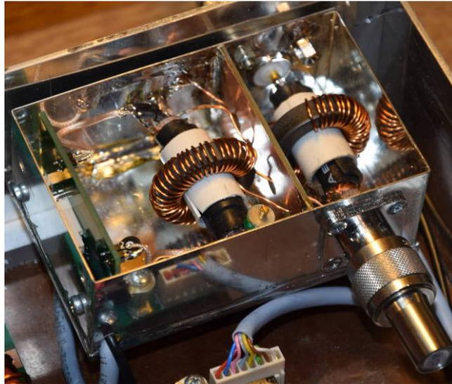
Ganz links ist die Messplatine. In der gleichen Kammer ist der Spannungsübertrager 36:1 und in der rechten Kammer der Stromübertrager 36:1.
