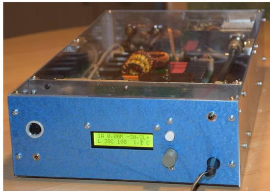
Der PicATU500, die 500 Watt-Ausführung. Mein erster Musteraufbau. Links sind 2 Buchsen für die Fernsteuerung. Wahlweise DIN 5 (mit Sicherheitsverschraubung) oder Stereo-Klinke 3,5mm. Rechts unten der Stromversorgungsanschluss 12 Volt. Der PicATU500 zieht maximal etwa 0,5 Ampere.
