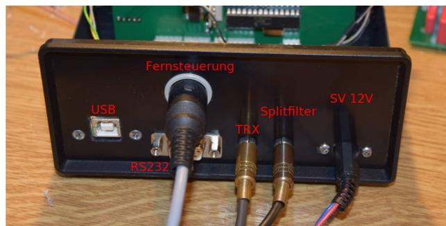
An der Rückwand sind alle Anschlüsse. Für das Split-Filter habe ich auch eine serielle RS232. Das Split-Filter schaltet je nach Frequenz die richtige Filterkombination. Die Fernsteuerleitung wird an eine DIN-Buchse angeschlossen (4 Drähte).
