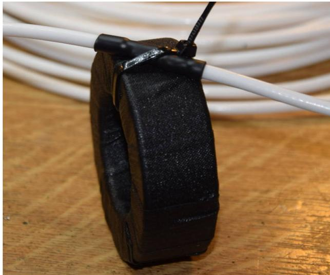
Mit Schrumpfschlauch überzogen und am Ringkern befestigt.
