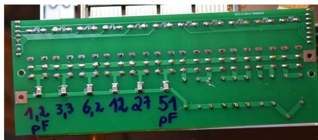
Ansicht der C-Platine von unten. Die SMD Kondensatoren haben eine Spannungsfestigkeit von 2kV. Ich bin mir aber nicht sicher ob die Cs die hohen HF-Ströme verkraften.
