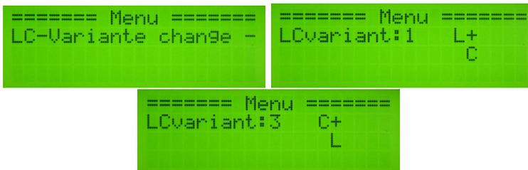
Hier im Beispiel habe ich an einer hochohmigen Antennen die LC-Variante gewechselt und anschließend mit *ReMatch* das SWR optimiert. Oft verbessert sich das SWR.
